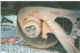
롤러베어링 풀러로 RR 화물기관차량의 마모된 베어링을 교환.
